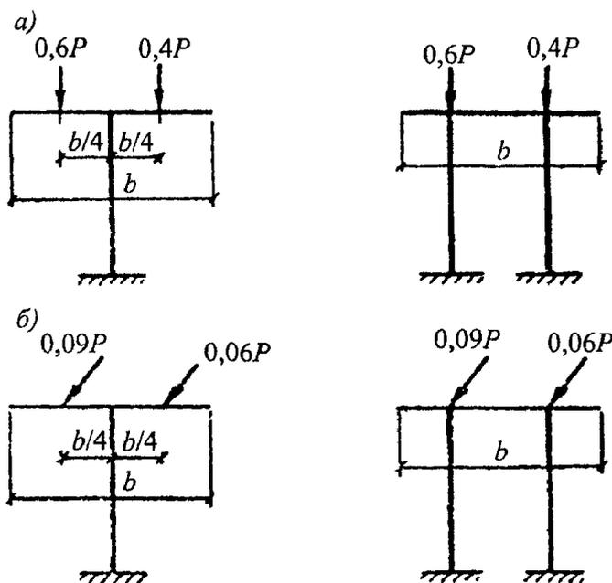
а - схема распределения вертикальной нагрузки; б - то же, горизонтальной нагрузки;  $P = pb$  - нормативная вертикальная нагрузка на опору или на соответствующий ярус опоры, где  $p$  - нормативное значение интенсивности вертикальной нагрузки на траверсу, определяемое по формуле (52)
