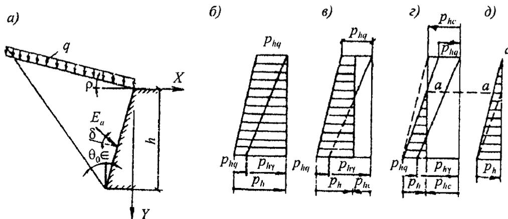
а - на стену; б - при отсутствии сцепления
