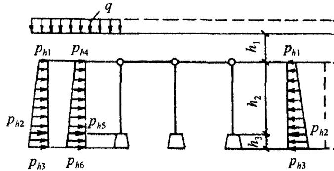
Рисунок 2 - Расчетная схема поперечной рамы подвала
